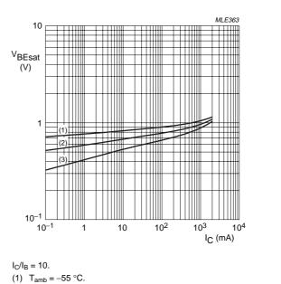
(1)  $T_{amb} = -55 \,^{\circ}\text{C}$ . (2)  $T_{amb} = 25 \,^{\circ}\text{C}$ . (3)  $T_{amb} = 100 \,^{\circ}\text{C}$ .
